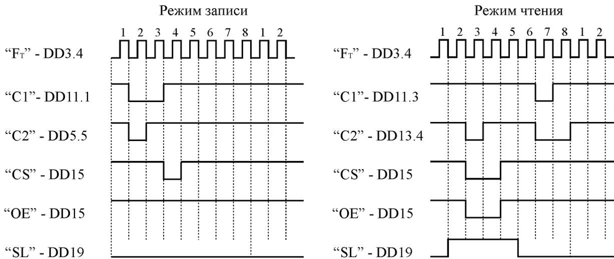
Примечание. Для сигналов "F<sub>T</sub>", "C1", "C2" указаны выходы логических элементов, для сигналов "CS", "OE", "SL" - соответствующие входы микросхем.
