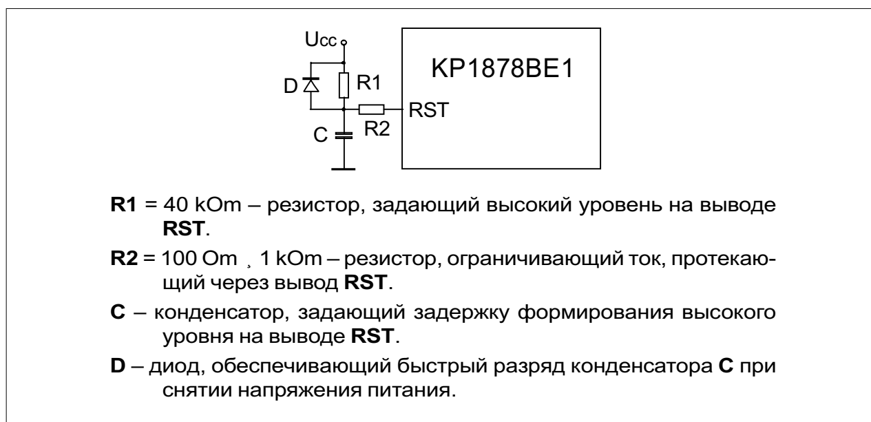
Рис. 15. Схема подключения для выработки сигнала RST
